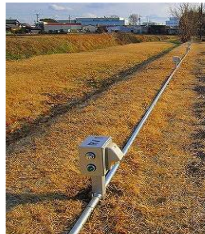
鉄パイプを用いた 敷設タイプ
